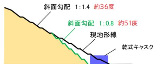
評価断面図(変更予定の形状)
